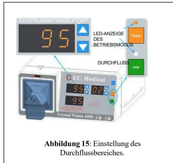
Abbildung 15: Einstellung des Durchflussbereiches.
