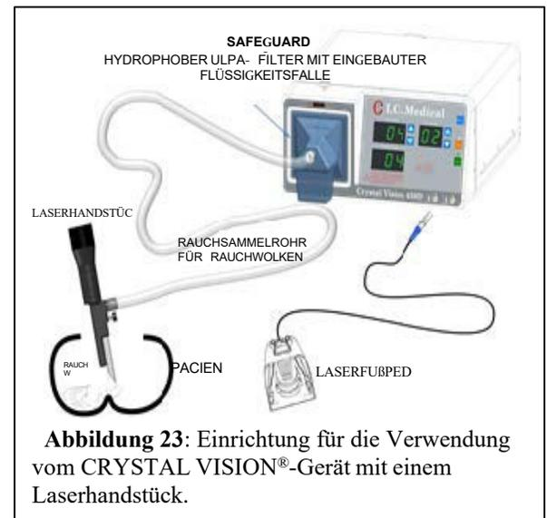
**Abbildung 23:** Einrichtung für die Verwendung vom CRYSTAL VISION®-Gerät mit einem Laserhandstück.
