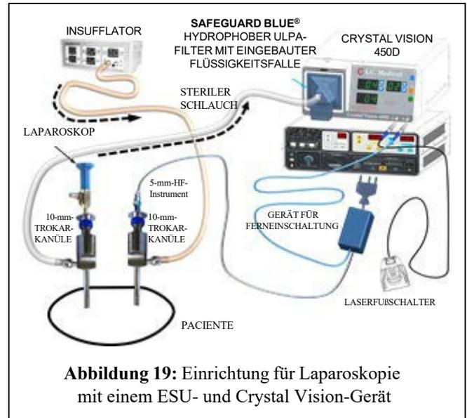
**Abbildung 19:** Einrichtung für Laparoskopie mit einem ESU- und Crystal Vision-Gerät
