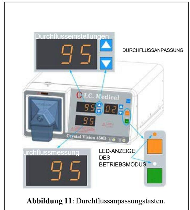
Abbildung 11: Durchflussanpassungstasten.
